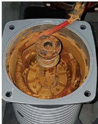
Interior del motor con el bobinado oxidado.
